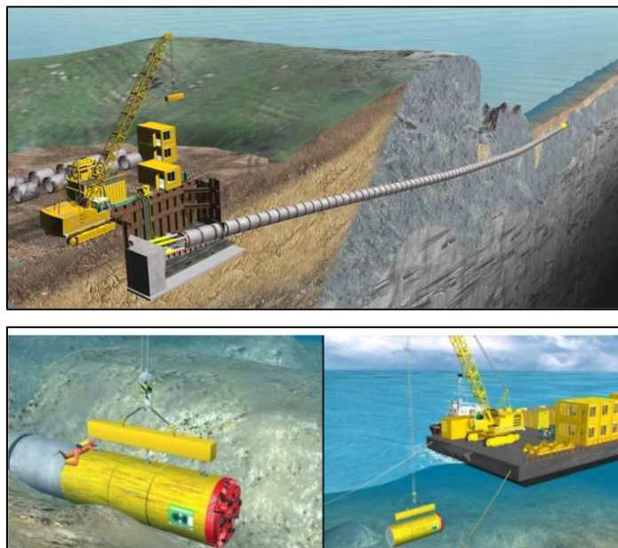
Figura 3.12. Riproduzione esemplificativa del microtunneling e del recupero finale della testa fresatrice
