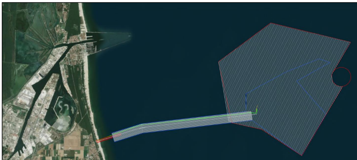
Figura 9.1. Rotte seguite con il MBES e con il Magnetometro (C2268_TECHEM_LNG RAVENNA_GEOFISICA).
